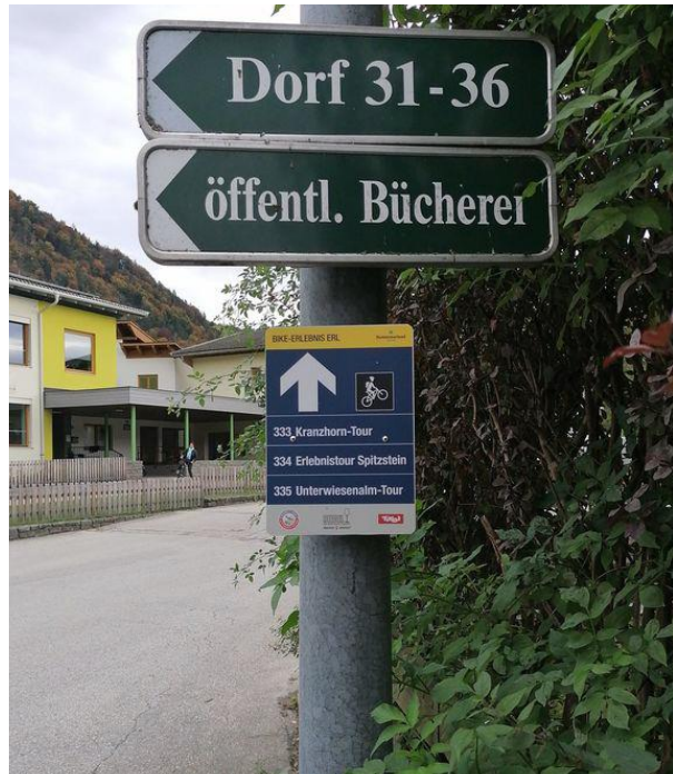
Abbildung 3: richtige Montage: Rechtwinklig zur Fahrtrichtung (frontale Draufsicht)
