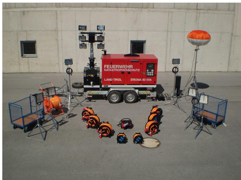
Stromerzeuger auf Anhänger mit Zubehör, zur Stromversorgung für Beleuchtungsgerät, elektrischbetriebene Pumpen und Rettungsgeräte im Katastrophenfall
