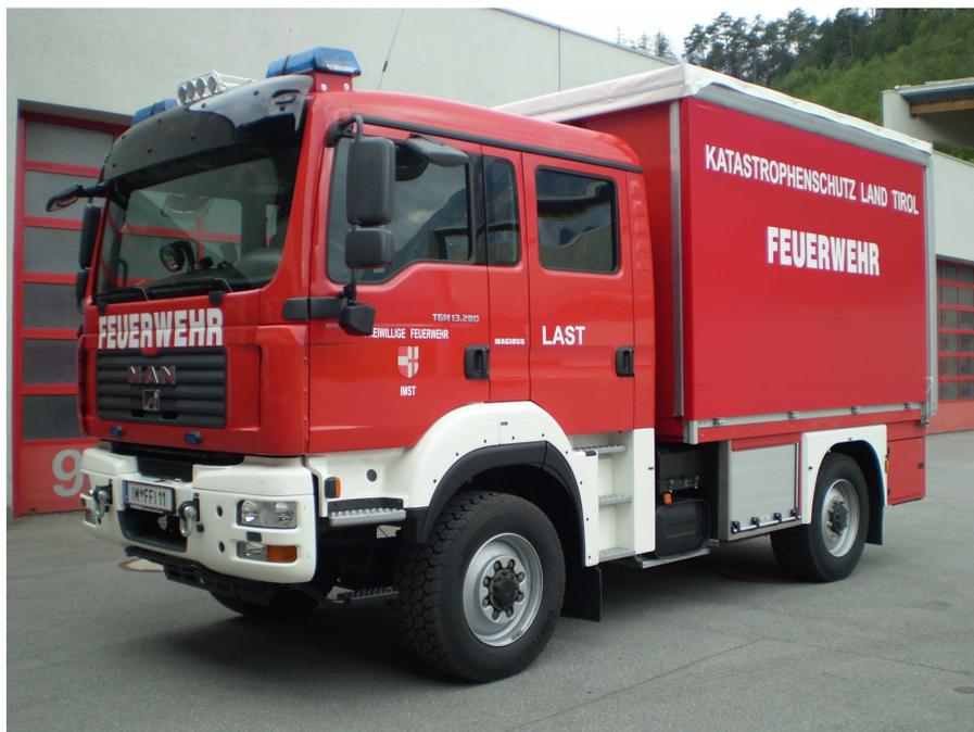
Lastfahrzeug einer Feuerwehr, mit überörtlichen Aufgaben wie Tunnelleinsatz, Flugdienst, Gefahrguteinsatz, Atemluftversorgung
