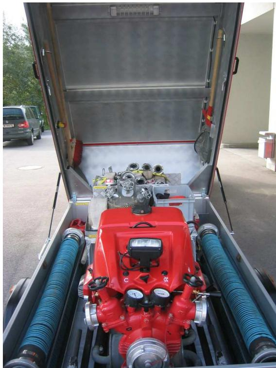
Anhänger, mit Pumpe, Schläuchen und Armaturen für die Löschwasserversorgung
