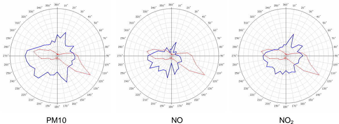
Abbildung 28: Schadstoffwindrosen für PM10, NO und NO 2 in Imst, Sommer 2003. Der Radius der Windrosen entspricht einer Windrichtungshäufigkeit von 20% (-----) bzw. einem HMW von 80 µg/m 3 (—)
