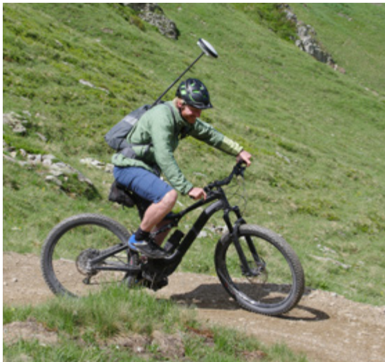
Abb.1.14: Erfassung des Wegverlaufs im Gelände mit dem Differenz GPS im Gelände.
