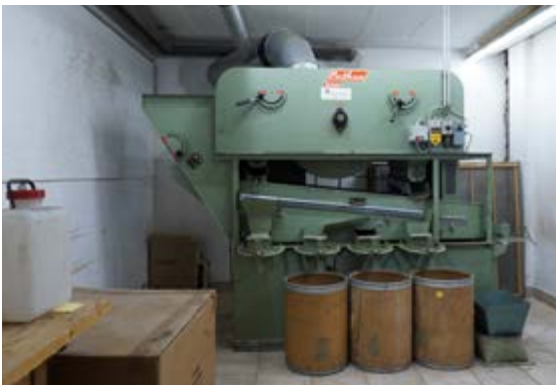
Abb.9.3: Die Maschine zur Saatgutreinigung im Forstgarten Nikolsdorf
