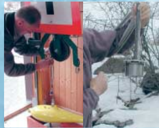
Ein sogenannter „Schwimmpegel“, für die Messung des Durchflusses, wird einsatzbereit gemacht (links). Auch die Wassertemperaturen werden am Pegel Hopfgarten erhoben (Bild rechts).
