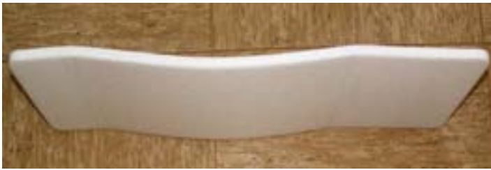
Verformung im Bodenteil einer Baby-Tragetasche nach Belastung
