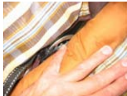
Quetsch- und Scherstelle im Bereich der Sitzfläche
