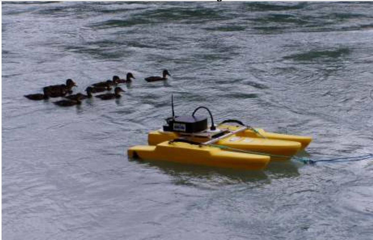
Ultraschalldurchflussmessgerät nach dem Dopplerprinzip mit Fernsteuerung; Vorführung am Pegel Innsbruck / Inn am 7.Juni 05 Foto: Hydrographischer Dienst Tirol
