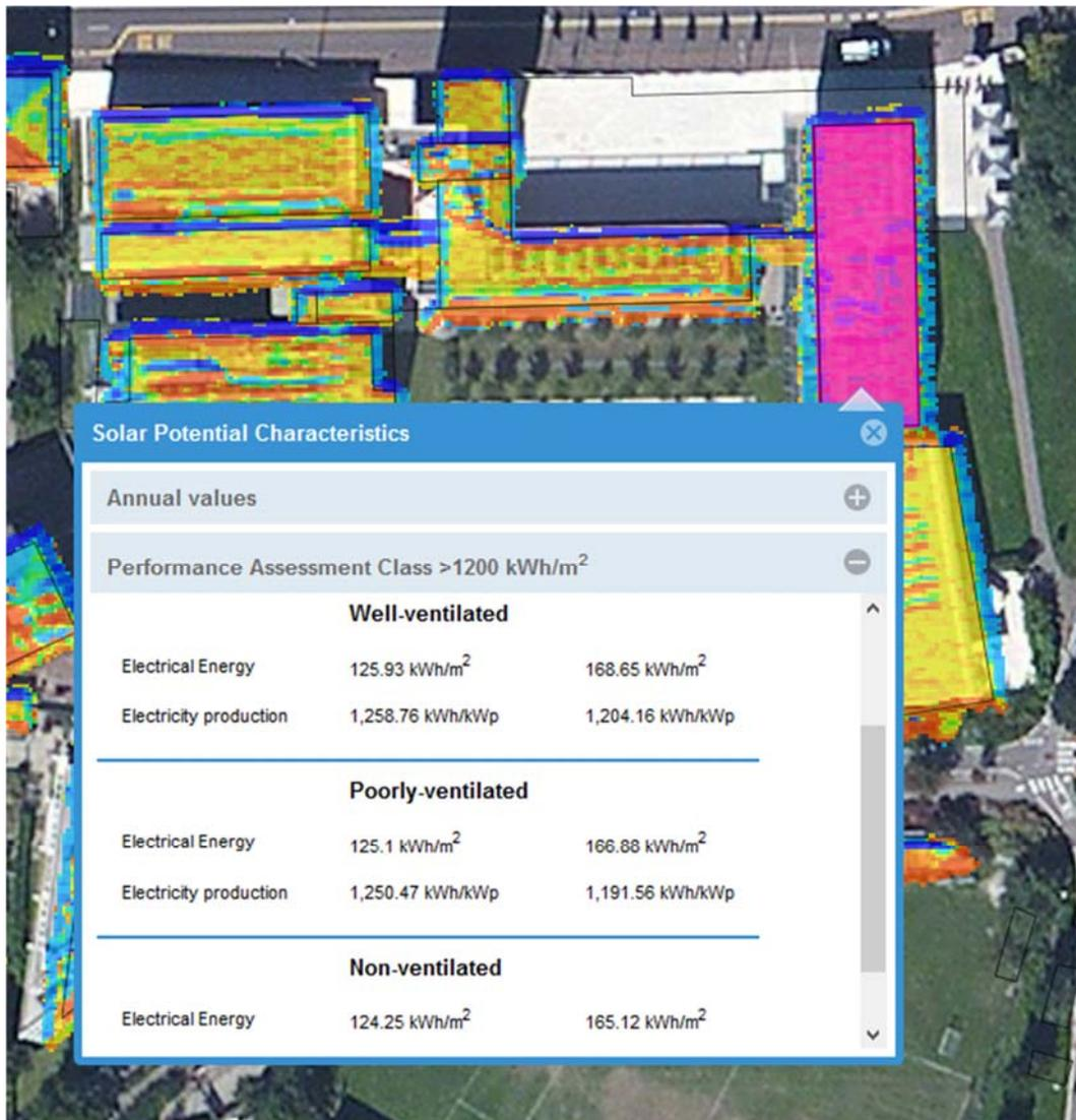
Figura 3: Effetto della ventilazione considerato nell'analisi della producibilità dell'impianto
