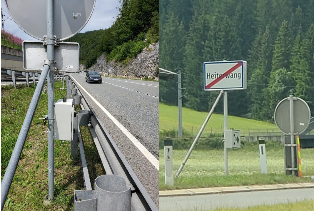
Abbildung 2-4: eigene Zählstellen mit Seitenradar in Heiterwang
