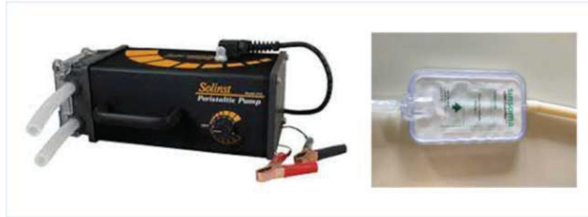
Abbildung A: Akku-Peristaltikpumpe (Solinst Modell 410) und eDNA Dual Filter Capsule (Sylphium) zur automatisierten Beprobung von eDNA
