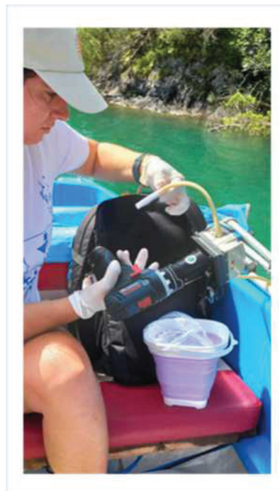
Abbildung B: Filtration mittels dem Buerkle™ Vampire Probensammler im Feld
