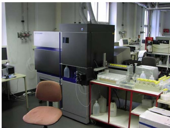
Analysesystem für induktiv gekoppelte Plasma-Atom-Emissionsspektroskopie (ICP)
