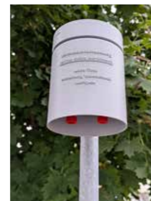
15 Passivsammler ergänzen das bestehende Luftgütemessnetz.
