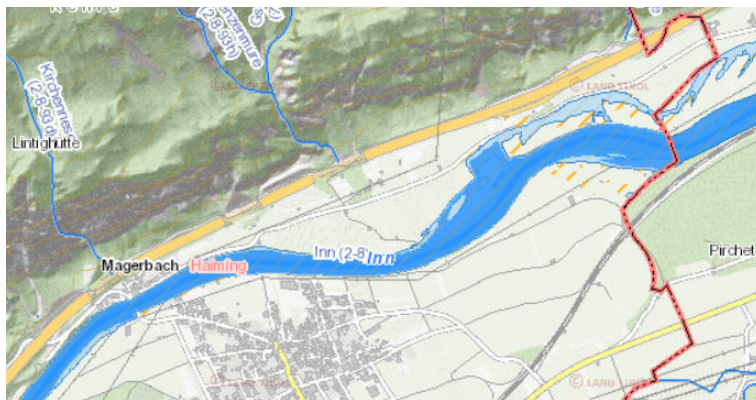
Abb. 2: Überflutungsflächen für HQ 30 (dunkelblau), HQ 100 (hellblau), HQ 300 (gelb schraffiert) und Retentionsbereich (rot schraffiert) in Haiming
