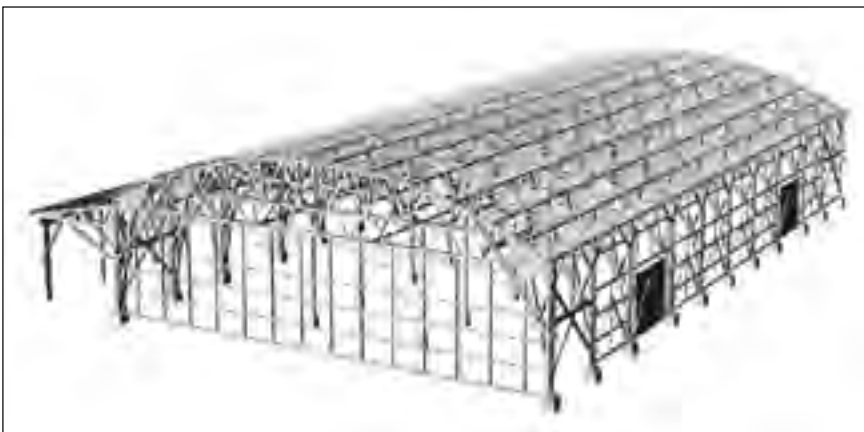
Axonometrisches Modell der Fachwerkskonstruktion (Gesamt), 2009 | Foto: Michael Treichl
