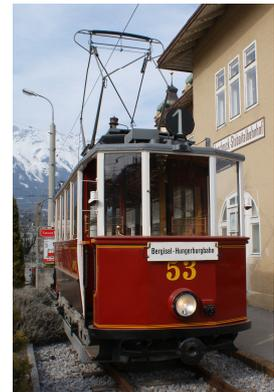
Zur Stromabnahme diente ein Lyra-Schleifbügel mit Aluminiumschleifleiste. Für den Betrieb mit Beiwagen standen eine Trichterkupplung, eine Steckdose für die Bremsstromübertragung (an der Stirnfront) sowie eine Steckdose für Licht- und Heizstrom (an der Dachkante) zur Verfügung.
