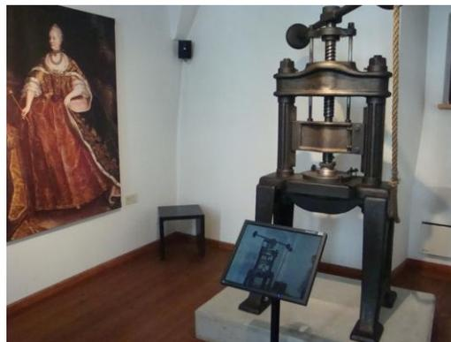
und die Produktionssteigerung nachvollziehen (bis 1500 Hammerprägung: 600 Münzen/Tag; um 1570: Walzenprägewerk 4200 Münzen/Tag; nach 1600 (in Hall ab 1748) Spindelpresse: 3000 Münzen/Tag; 1817 Kniehebelpresse: 60 Münzen/Minute). Bei jeder Maschine steht ein Videoterminal, der sie in Funktion zeigt.
