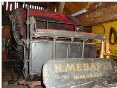
Die Holzräder von einst bestanden in der Regel aus verschiedenen, gut abgelagerten Harthölzern. Über das fertige hölzerne Speichen-Rad legte der Schmied den heißglühenden Metallreifen. Die Herstellung eines Rades erforderte technisches Wissen, Erfahrung und Materialkenntnis. Die Aufbauten komfortabler Kutschen wurden dann mit Leder verkleidet, die Sitze gepolstert. Die Reisekutsche der Firma
