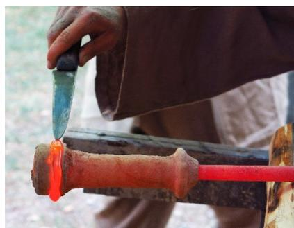
Wie zähflüssigen Honig wickelt man das erhitzte Glas um einen Zylinder aus Ton.<sup>18</sup>
