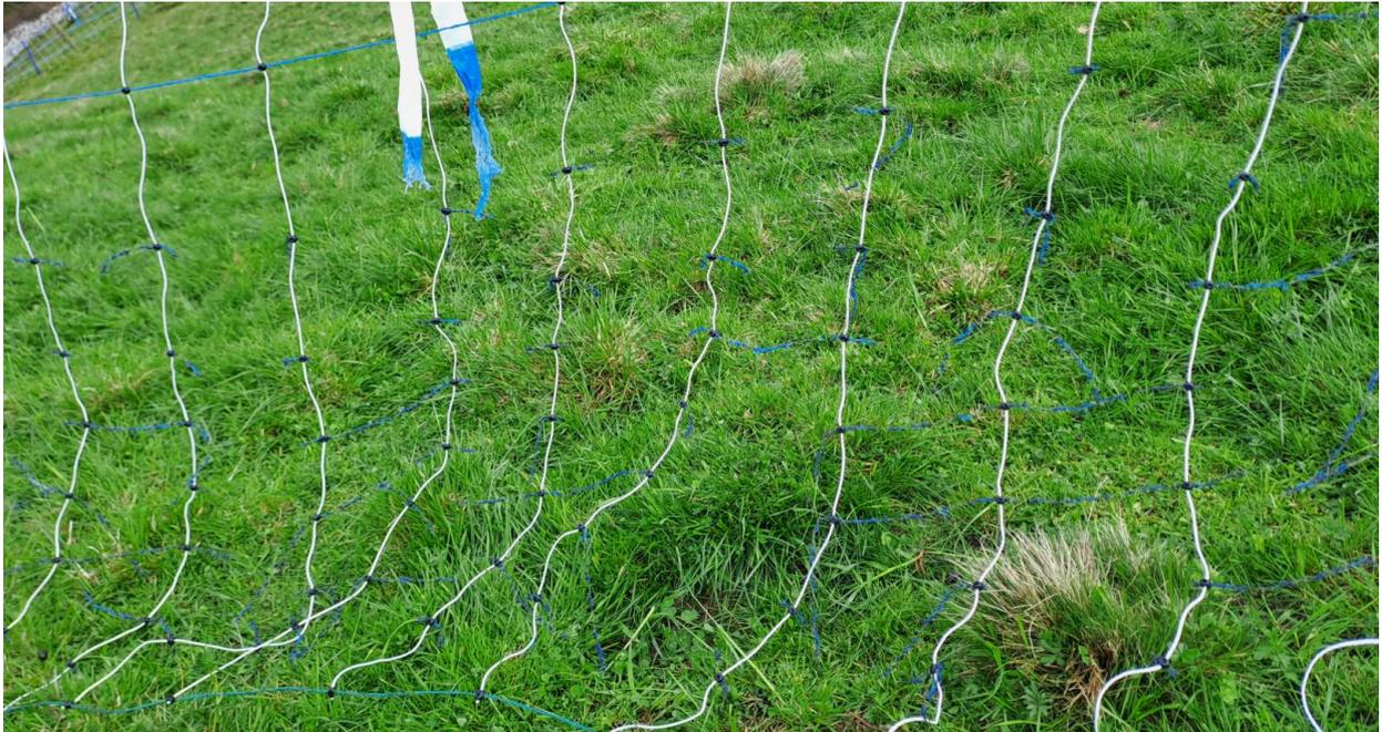
**Abbildung 6: Durch den Blitzeinschlag in die Hütte verpuffte das Leitermaterial in den stromführenden Litzen des angrenzenden Weidenetzes und zerstörte dabei auch die Kunststofflitzen selbst (Foto Alois Marth)**
