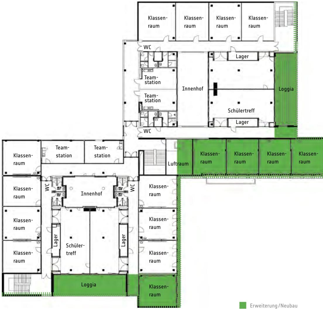
Abb. 125: Umbau 2. Obergeschoss Bauteil A/B, M 1:500
