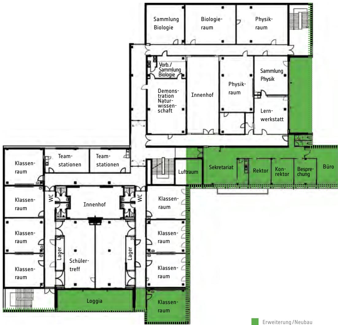
Abb. 122: Umbau 1. Obergeschoss Bauteil A/B, M 1:500
