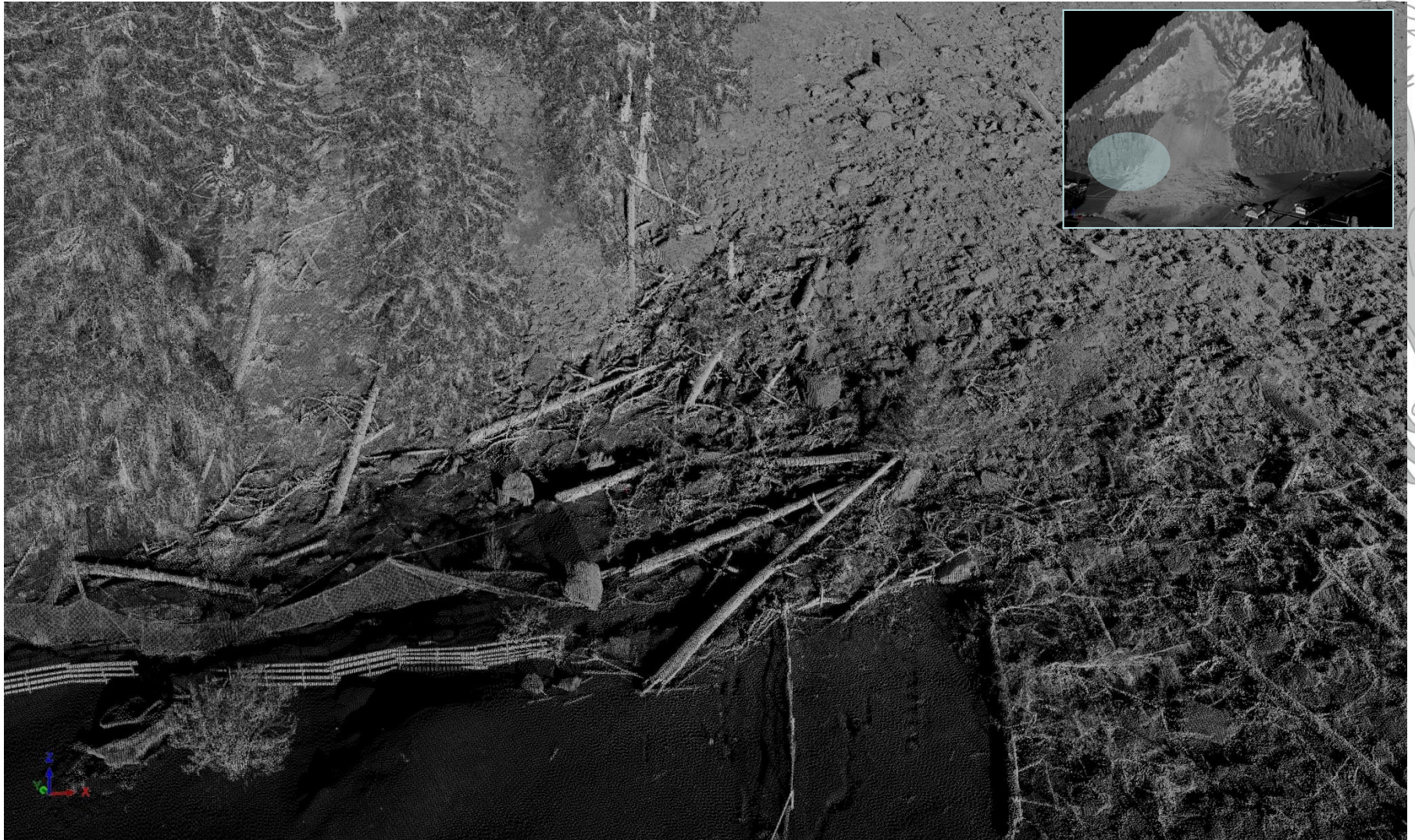
3D Punktwolke , Färbung aufgrund Reflektivität (Detail), Stand 27.12.2017
