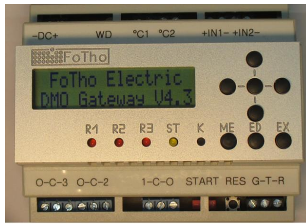
Abb. 4, SMS Steuerung zum Aktivieren und Deaktivieren eines stationären DMO Gateways/Repeatern
