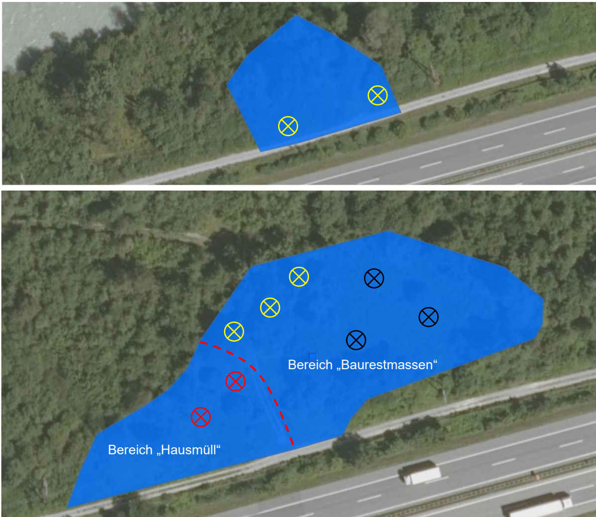
Abb. 3: Schürfe Detailerkundung, oben: Verdachtsfläche 1, unten: Verdachtsfläche 2, rot: Schürfe ES1 und ES2 mit hohem Anteil an „Hausmüll“ und vermutete Grenze dieses Bereichs, gelb: Schürfe ES3 bis ES5 ohne (bis vereinzelt) bodenfremdes Material, schwarz: Schürfe ES6 bis ES8 mit vermehrt „Baurestmassen“.
