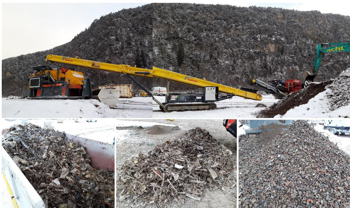
Abb. 8: Zusätzlicher Aufbereitungsschritt der Mittelfraktion im Bereich Hausmüll, oben: Aufbereitung durch Brecher, Förderband und Widsichter, links: vom Windsichter ausgeblasene Störstoffe, mitte: durch Magnetabscheideband aussortierte kleine Metallteile, rechts: Auswurf des aufbereiteten Materials
