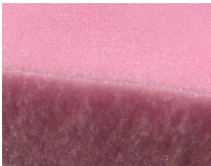
Abbildung 5: Bruchfläche einer XPS-Dämmplatte, Bild: Johann Jandl (ÖXPS)
