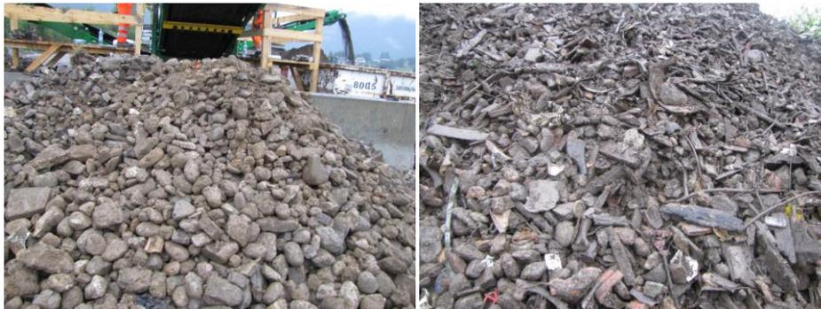
Abb. 22: Kaum verunreinigtes Mittelkorn aus einer oberen (links), stark verunreinigtes Mittelkorn aus einer unteren Aushubsschicht
