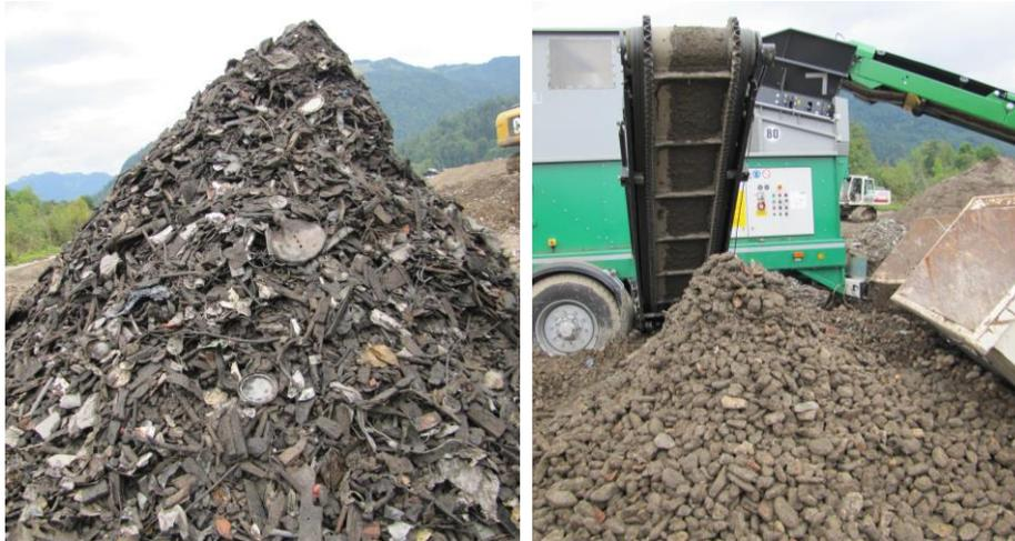
Abb. 24: Vom Windsichter abgeschiedene Anteile <sup>16</sup> (links), „gereinigtes“ Mittelkorn aus einer Schicht mit hohem Müllanteil (rechts)
