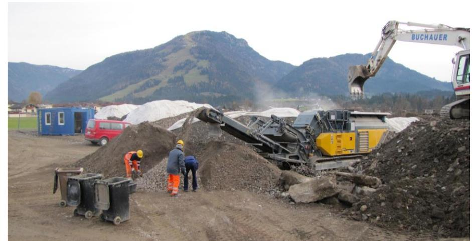
Abb. 21: Versuchsweise Zerkleinerung von „Überkorn“ mit händischer Störstoffkontrolle (17. November 2014)
