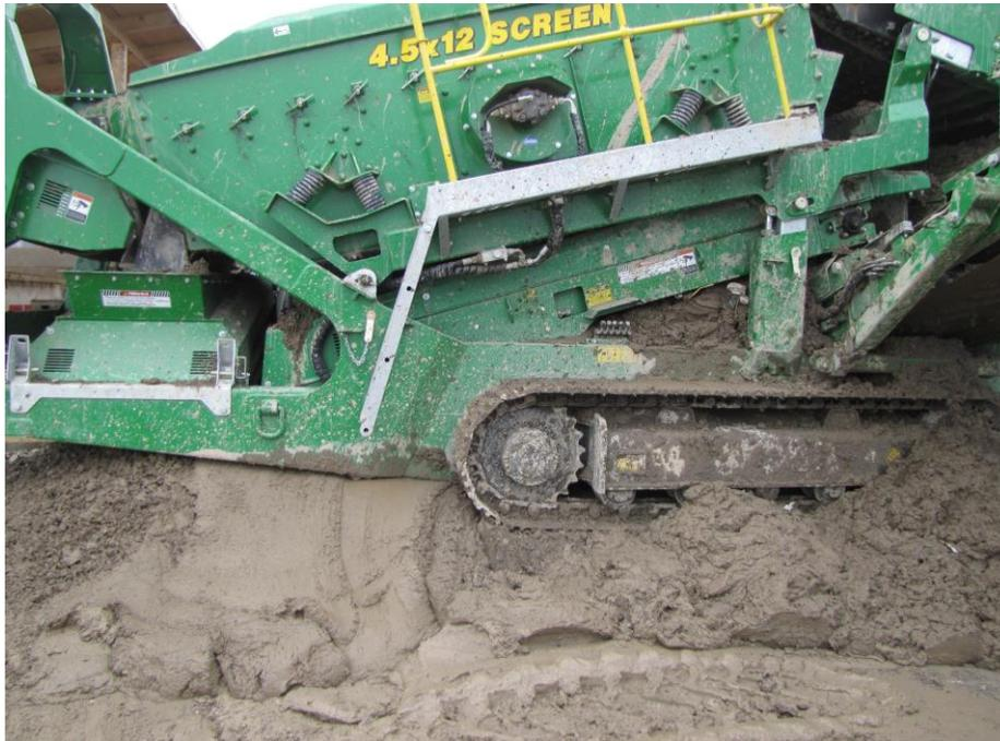
Abb. 27: Sieb bei Verarbeitung von nassem Mittelkorn (25. Feber 2015)
