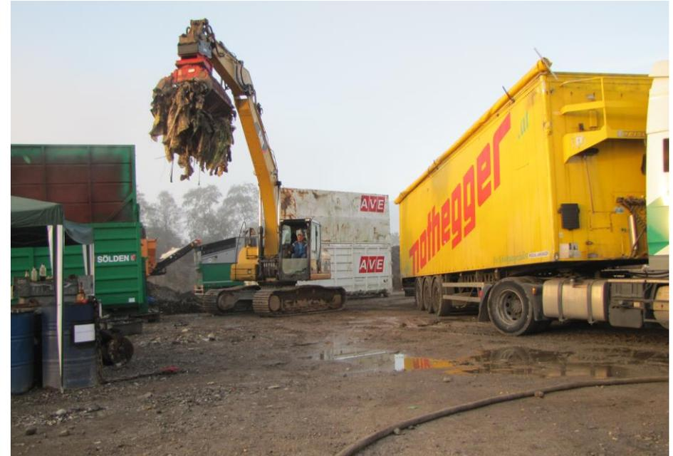
Abb. 42: Verladung von Restmüll aus gedecktem Lagercontainer (links) in LKW mit Schubbodenaufbau („Walking Floor“) 90 m<sup>3</sup>
