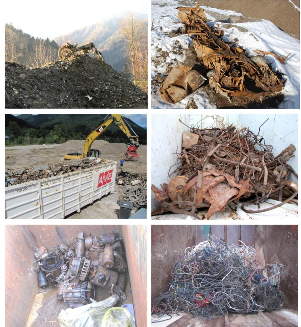
Abb. 36: Von links oben im Uhrzeigersinn: Wracks eines Motorrads (eine Horex Regina, Baujahr um 1955) und Postautos (Foto: H. Brinkmann) als Beispiele für Eisenschrott Sorte E 1, Eisenschrott Sorte E 3, Kupferkabel isoliert, Elektromotoren und im 38 m<sup>3</sup>-Abrollcontainer verladener Eisenschrott E 1.
