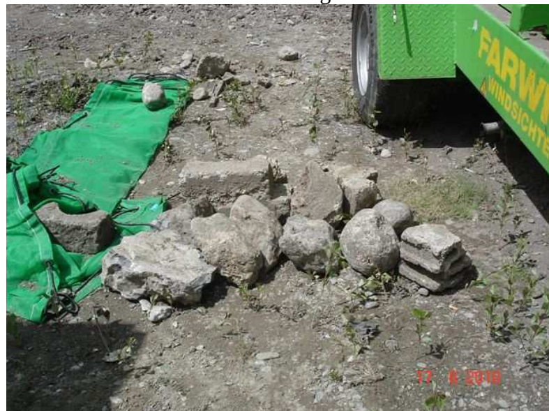
Steine welche Siebanlage blockierten
