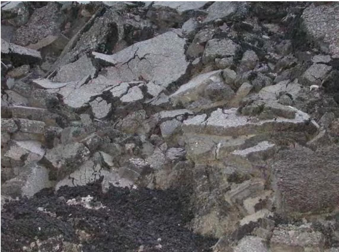
Abb. 03: Straßenaufbruch bituminös (Asphaltbruch), Firma Plattner & Co
