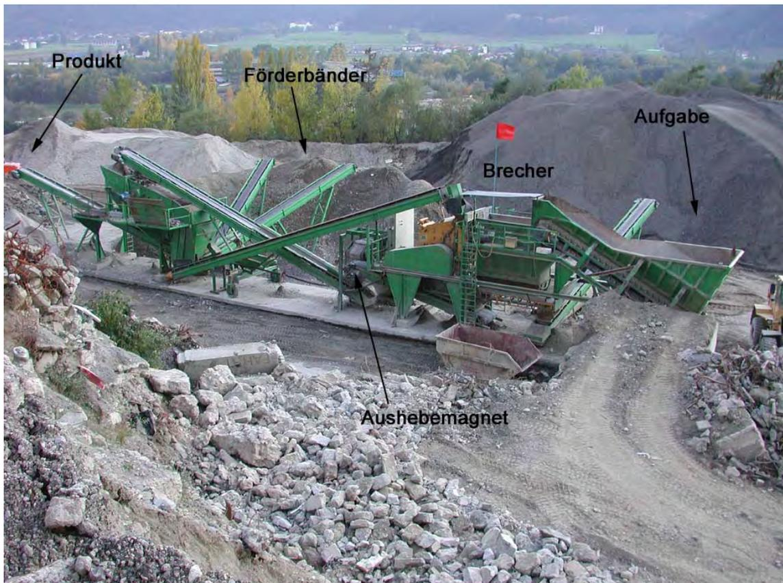
Abb. 38: offene stationäre Aufbereitungsanlage (Firma Plattner)
