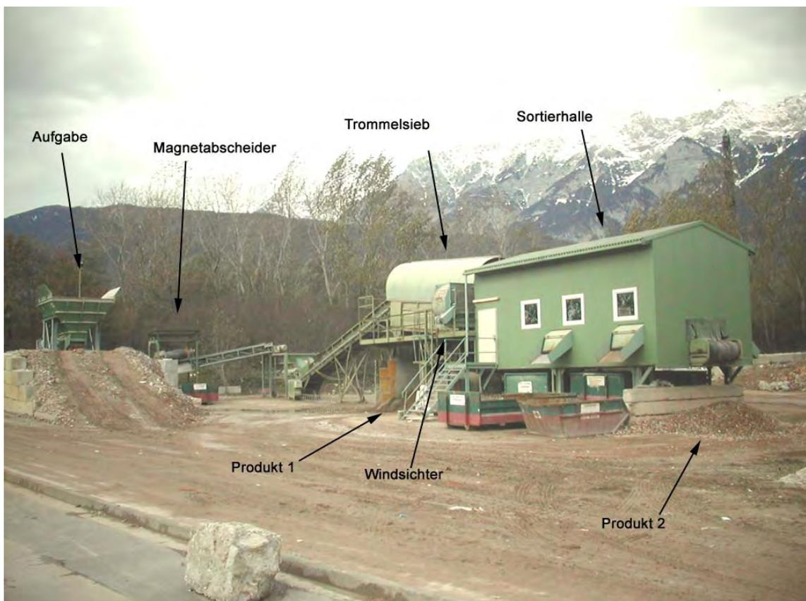
Abb. 39: Stationäre Aufbereitungsanlage (Firma Derfesser Recycling & Entsorgung Pill)
