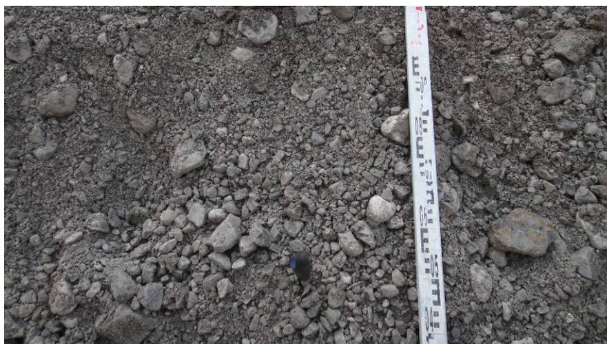
Abbildung 3: Typisches Aushubmaterial aus Geschieberückhaltebecken
