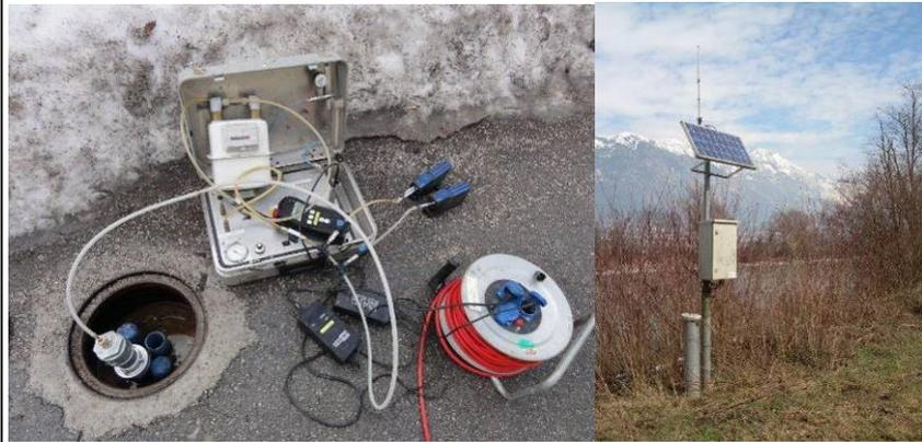
Messeinrichtungen für Bodenluft- bzw. Grundwasser
