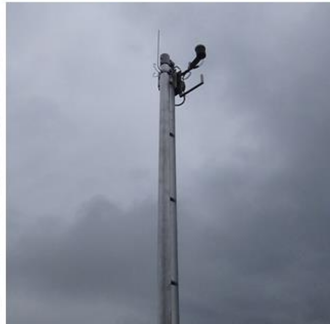
Abbildung A1: Die TEMPIS-Station Hauptbahnhof (HBF) befindet sich östlich der Gleise des Hauptbahnhofs in der Stadt, auf dem Satellitenfoto (oben) ist der Standort mit einem gelben Marker gekennzeichnet (Quelle: Google Earth). Auf dem Schlauchturm der Berufsfeuerwehr (unten links) sind auf einem 6 m hohen Mast (unten rechts) Temperatur-, Feuchte- und Windsensor montiert.
