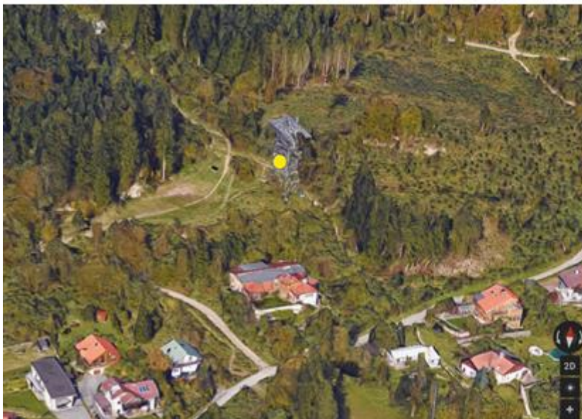
Abbildung A4: TEMPIS-Station Hungerburg (HBG) auf der Hangverflachung des namengebenden Stadtteils (oben, GoogleMaps, auf dem rot strichlierten Trassenverlauf der Nordkettenbahn mit rotem Marker). Die Sensoren für Temperatur- und Feuchte sind auf der 1. Stütze der Nordkettenbahn (unten links, 3D-GoogleMaps, gelb markiert) in 11,5 m über Grund montiert (unten rechts, gelb eingekreist).
