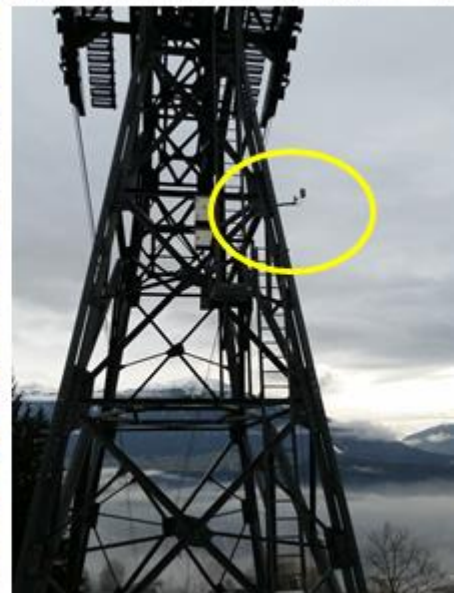
Abbildung A4: TEMPIS-Station Hungerburg (HBG) auf der Hangverflachung des namengebenden Stadtteils (oben, GoogleMaps, auf dem rot strichlierten Trassenverlauf der Nordkettenbahn mit rotem Marker). Die Sensoren für Temperatur- und Feuchte sind auf der 1. Stütze der Nordkettenbahn (unten links, 3D-GoogleMaps, gelb markiert) in 11,5 m über Grund montiert (unten rechts, gelb eingekreist).
