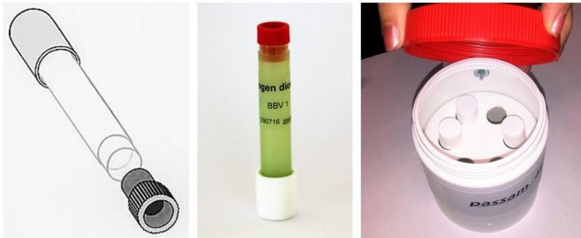
Abbildung 3-1. Schematische Darstellung des Passivsammlers für Stickstoffdioxid ( \text{NO}_2 ; links); Passivsammler des Röhrchen-Typs (Mitte); ein (am Boden offener) Schutzbüchsenbehälter zur Installation der Passivsammler (rechts) (Quelle: passam AG).
