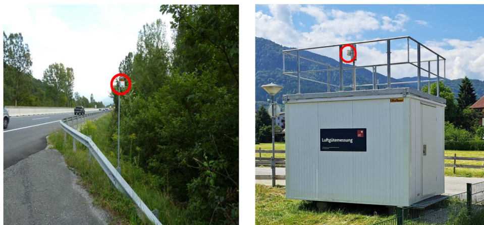
Abbildung 3-2. Beispiele für typische Messstandorte im Passivsammler-Messnetz. Links: Messstelle Zirl Dirschenbach A12 (km 93,3) als verkehrsnaher Standort. Rechts: Referenzmessstelle Wörgl Stelzhammerstraße, mit Anbringung des Passivsammlers neben der Ansaugöffnung des kontinuierlich messenden Messgeräts APNA 370 für die NO_2 -Referenzmessung. Die roten Kreise heben die Passivsammler in den Fotos hervor.
