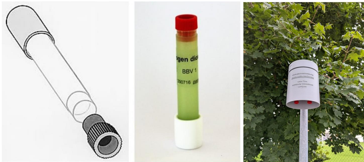
Abbildung 4-1. Schematische Darstellung des Passivsammlers für Stickstoffdioxid ( \text{NO}_2 ; links); Passivsammler des Röhrchen-Typs (Mitte); ein (am Boden offener) Schutzbehälter zur Installation der Passivsammler (rechts) (Quelle: passam AG; Gruppe Forst).
