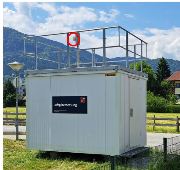
Abbildung 4-2. Beispiele für typische Messstandorte im Passivsammler-Messnetz. Links: Messstelle Zirl Dirschenbach A12 (km 93,3) als verkehrsnaher Standort. Rechts: Referenzmessstelle Wörgl Stelzhammerstraße, mit Anbringung des Passivsammlers neben der Ansaugöffnung des kontinuierlich messenden Messgeräts für die NO 2 -Referenzmessung. Die roten Kreise heben die Passivsammler in den Fotos hervor (Quelle: Gruppe Forst).
