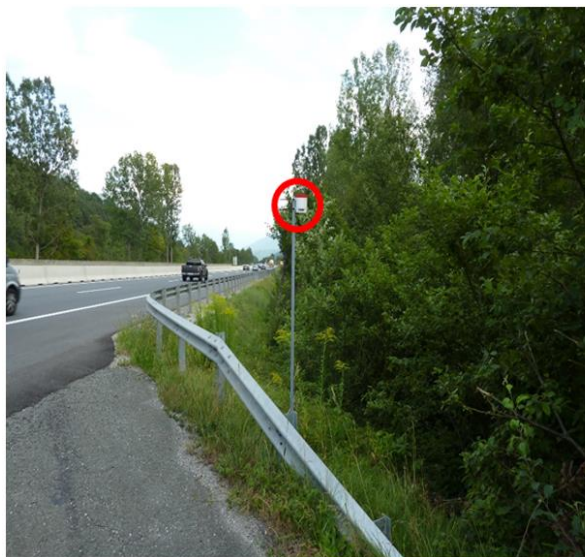
Abbildung 4-2. Beispiele für typische Messstandorte im Passivsammler-Messnetz. Links: Messstelle Zirl Dirschenbach A12 (km 93,3) als verkehrsnaher Standort. Rechts: Referenzmessstelle Wörgl Stelzhammerstraße, mit Anbringung des Passivsammlers neben der Ansaugöffnung des kontinuierlich messenden Messgeräts für die NO 2 -Referenzmessung. Die roten Kreise heben die Passivsammler in den Fotos hervor (Quelle: Gruppe Forst).
