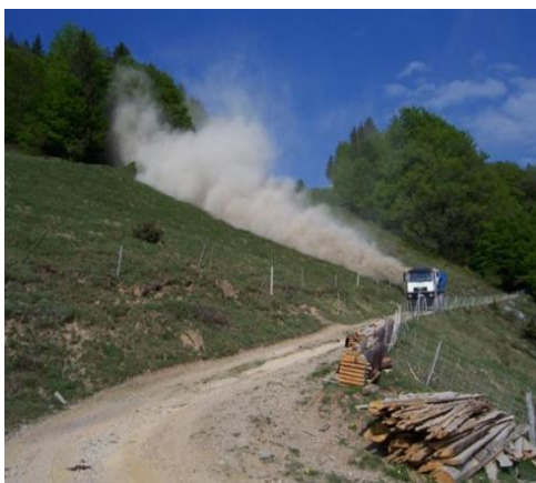
Abbildung 23 und 24: Nassverblasung von Kalk mittels patentiertem Verfahren der Schneider Verblasetechnik e.K. (Quelle: Fa. Schneider)
