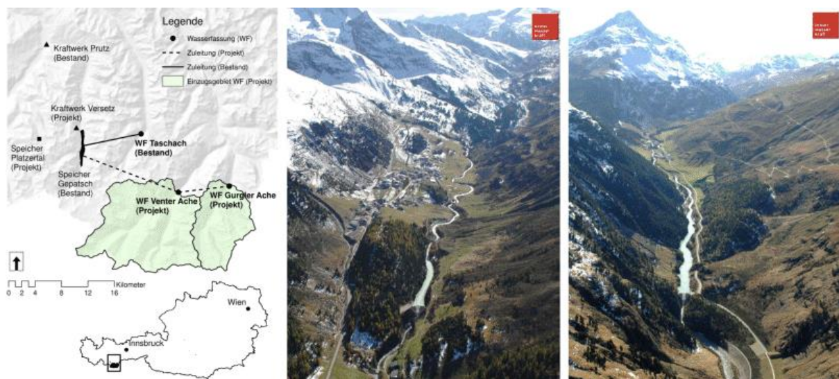
Abbildung 4.1.4: links: Projektgebiet; Mitte: Fotomontage Wasserfassung Gurgler Ache; rechts: Fotomontage Wasserfassung Venter Ache; aus Plörer et al. (2017)
