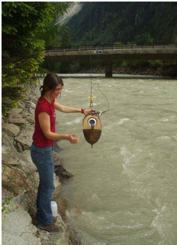
Marlene Haimann/Universität für Bodenkultur beschickt den US-P61 Sampler mit einer Probeflasche
