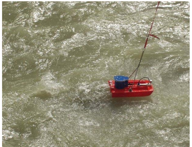
Härtetest für das „StreamPro ADCP“ von RDI bei schwacher Mittelwasserführung der Öztaler Ache
