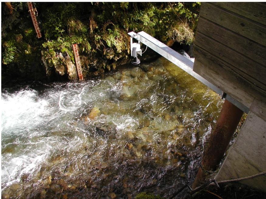
Der Pegel wurde mit einem Wasserstands-RADAR und einer Datenfernübertragung sowie elektrischem Strom nachgerüstet.
