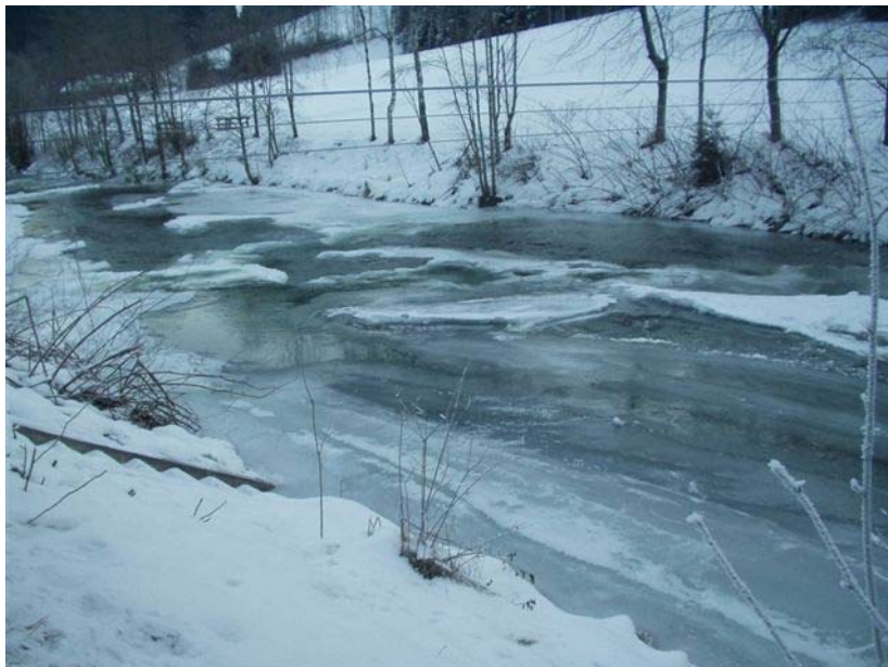
Die Pegelstelle Hörbrunn/Kelchsauer Ache (Kitzbüheler Alpen) im Würgegriff von Randeis, Grundeis und winterlicher Schneedecke, die den Lattenpegel an der Pegelstiege unlesbar macht.
