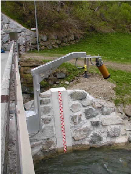
Pegel Ischgl-Plattbrücke an der Trisanna: Anfang Mai wurde diese Pegelstelle fertiggestellt und in Betrieb genommen. Erfasst werden Wasserstand (Lattenpegel und RADAR), Oberflächengeschwindigkeit (RADAR) und Wassertemperatur (NTC-Fühler).
