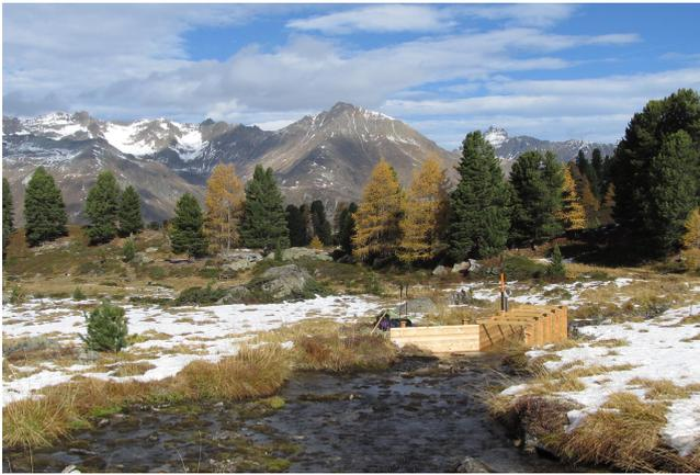
Messgerinne für die Wasserstandserfassung am Fuße des Berglerloch-Blockgletschers in der Silvretta/Gemeinde Ischgl. Die Parameter Wassertemperatur und elektrische Leitfähigkeit werden an der Stirn des Blockgletschers erfasst.
