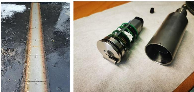
Foto: Land Tirol, Hydrographischer Dienst; Geophonanlage Messbalken (linkes Bild), geöffnete Schwebstoffsonde (rechtes Bild)
