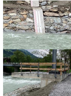
Pegelanlage mit Lattenpegel und Messgerätaufnahmen
