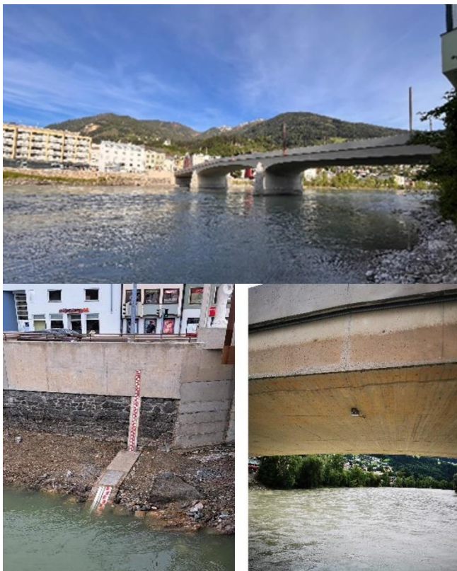
Foto Pegel Schwaz (Steinbrücke) und Radarsensor an der Brückenunterseite;
