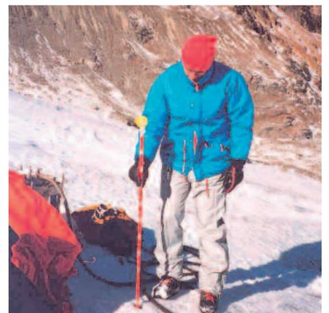
Mit dem Dampfbohrer werden im Spätsommer mehrere Meter tiefe Löcher vertikal in das Eis gebohrt, in welche die Eispegel gesteckt werden. Im Laufe der Schmelzperiode des nachfolgenden Haushaltsjahres apert diese Schneepiegel aus und geben so Aufschluss über den Eisverlust des Gletschers an dieser Stelle. Wenn diese Pegel geodätisch eingemessen werden, so sind auch Aussagen über die Fließgeschwindigkeiten des Gletschers möglich.
