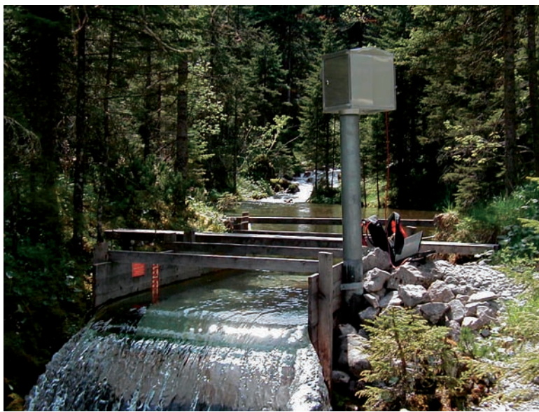
Messstelle für Schüttung, Wassertemperatur und elektrische Leitfähigkeit an einer Quelle
