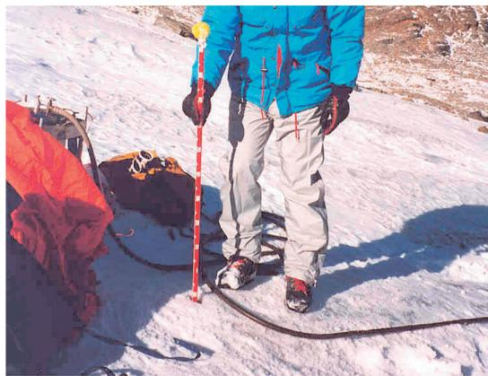
Mit dem Dampfbohrer werden im Spätsommer mehrere Meter tiefe Löcher vertikal in das Eis gebohrt, in welche die Schneepiegel gesteckt werden. Im Zuge der Schmelzperiode des nachfolgenden Haushaltsjahres apert diese Schneepiegel aus und geben so Aufschluss über den Eisverlust des Gletschers an dieser Stelle. Wenn diese Pegel geodätisch eingemessen werden, so sind auch Aussagen über die Fließgeschwindigkeiten des Gletschers möglich.
