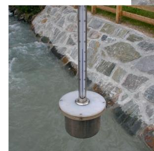
Schöpftthermometer für Wassertemperaturmessung
