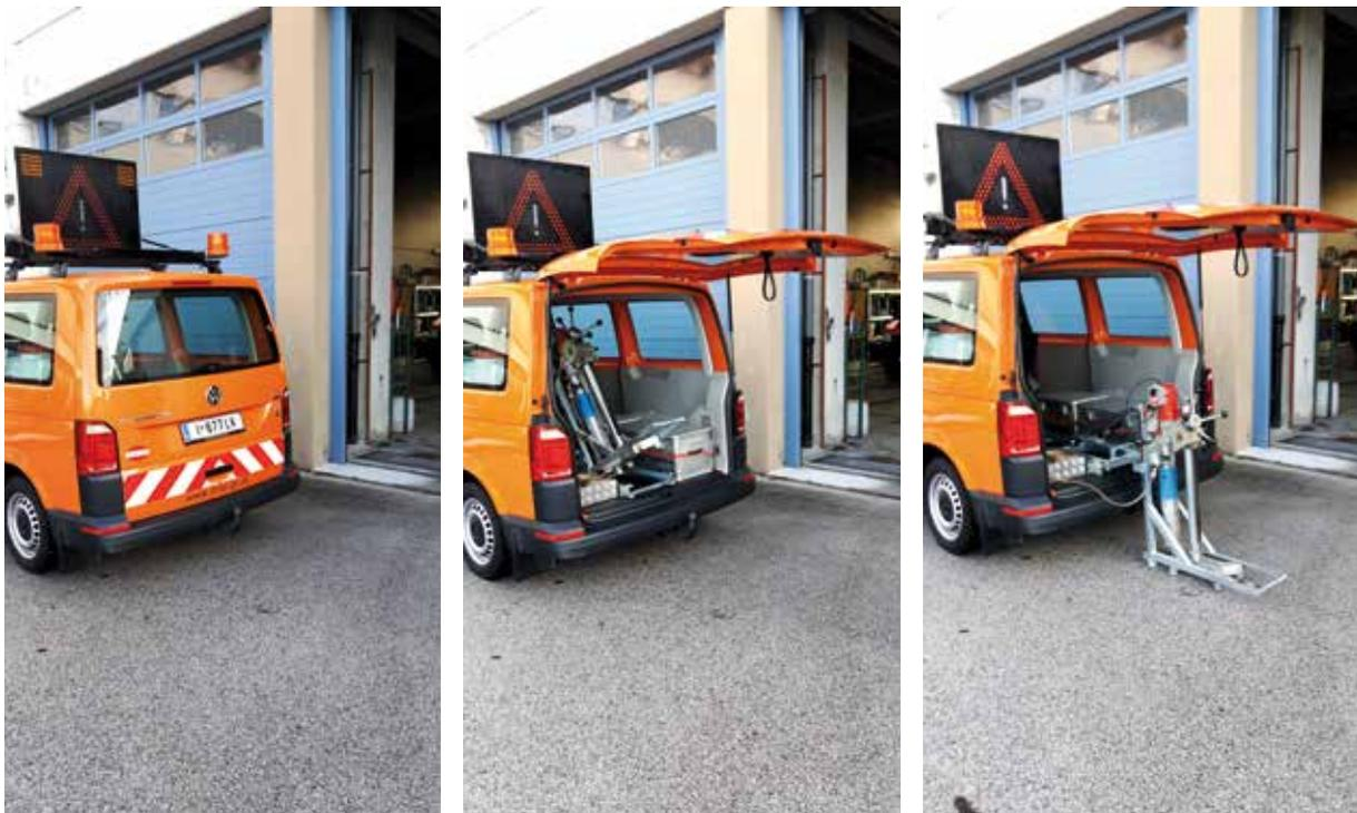
Neues Transportfahrzeug mit integriertem Asphaltkernbohrgerät
