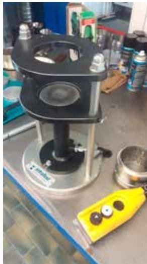
• **Ausformpresse Marshallprobekörper**
