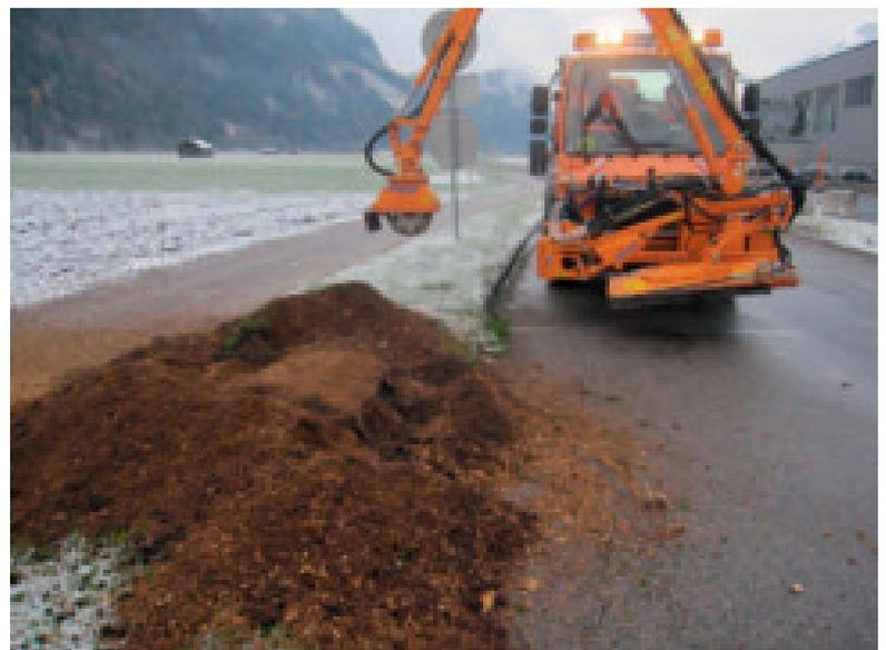
Mit Spezialanbaugeräten können vielfältige Arbeiten durchgeführt werden, wie hier mit einer sogenannten Stockfräse an einem Unimog für das Fräsen von Wurzelstöcken.
