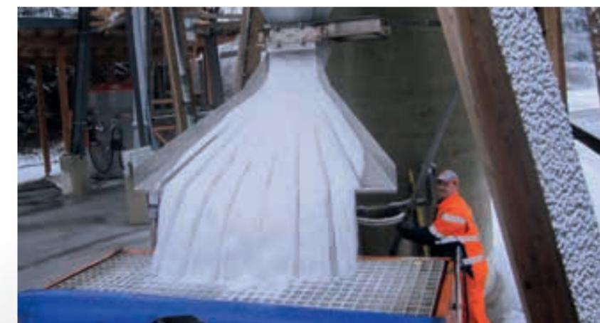
Befüllung eines Unimog-Streugerätes mit Streusalz
