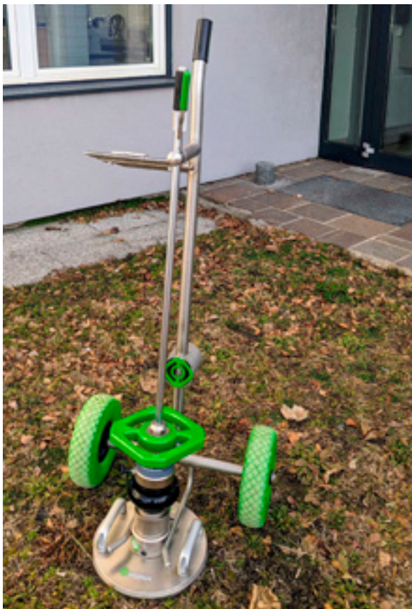
Leichtes Fallgewichtsgerät zur Überprüfung der erfolgreichen Verdichtung des Untergrundes
