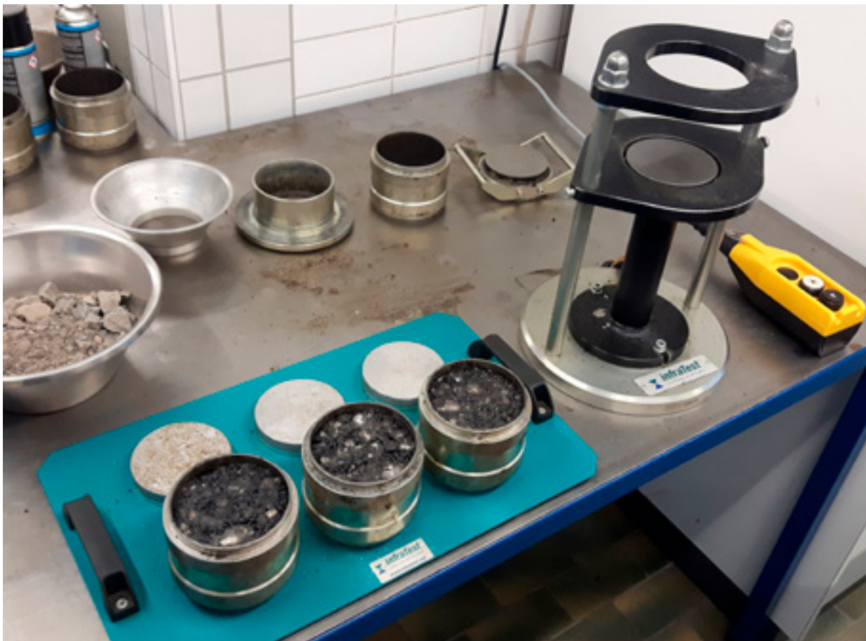
Asphaltmarshalkörper vor dem Auspressen aus der Form
