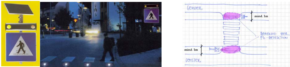
Abbildung 9: Hinweiszeichen mit zusätzlichen Blinkleuchten und Unterflurkennzeichnung in LED-Technologie, vorgezogene Aufstellfläche
